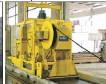
Sistema de limpieza de lecho al vacío
