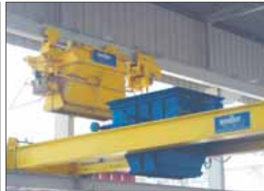
Suministro de hormigón totalmente automático
