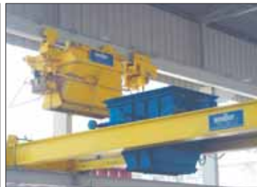
Suministro de hormigón totalmente automático
